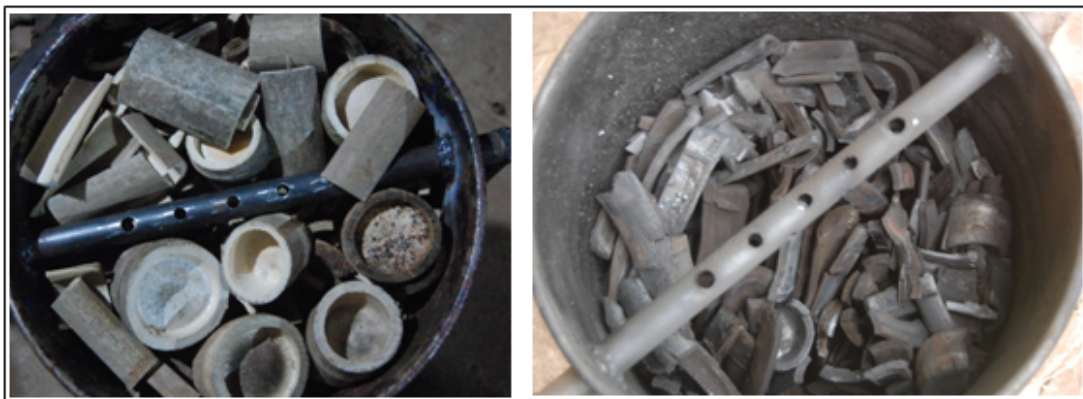
Figura 3: Reator portátil tipo retorta de tambor de aço mostrando a carga fresca de bambu e depois com o carvão produzido. Fonte: Autor
