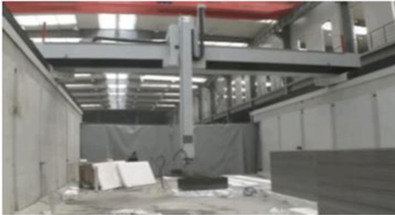
Figura 4 - Estrutura impressora WinSun
