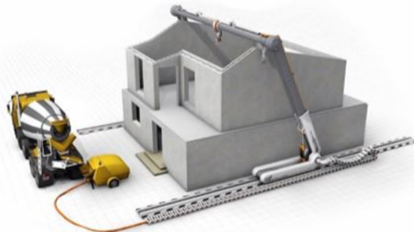
Figura 5 - Modelo estrutural impressora Contour Crafting
