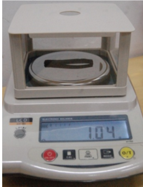
Figura 2: Balança digital de precisão, com resolução de 0,01g. (Fonte: O autor)
