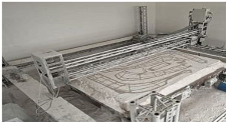
Figura 2 - Estrutura da impressora D-Shape
