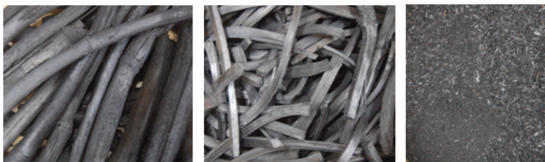
Figura 1: Carvão de bambu produzido de: colmos de Drepanostachyum falcatum , lascas de colmos de Phyllostachys pubescens e serragem de corte de colmos de Dendrocalamus asper . (Produzido pelo autor)
