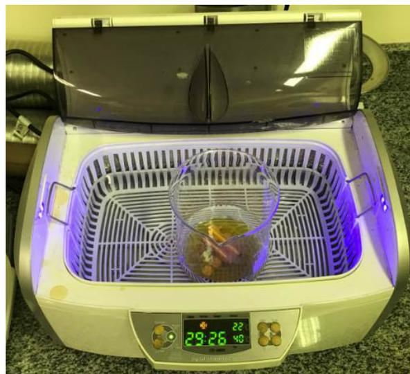
**Figura 7: Banho ultrassônico**
