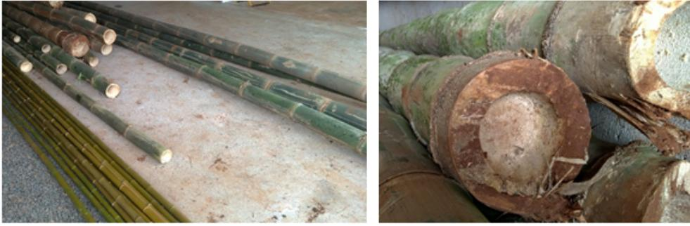
**Figura 1: Colmos de cana-da-índia e bambu gigante. Espécies disponíveis e adequadas para uso estrutural**
