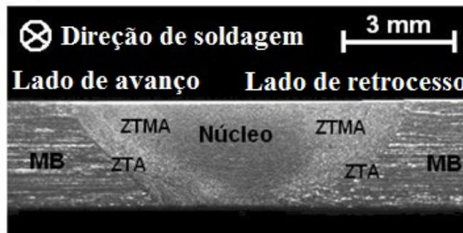
**Figura 5: Seção transversal de uma junta soldada da liga AA1050 por FSW**
