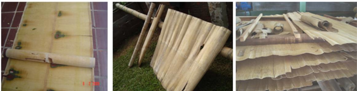
**Figura 13: Lâminas finas e largas de bambu gigante, obtidas por torneamento**
