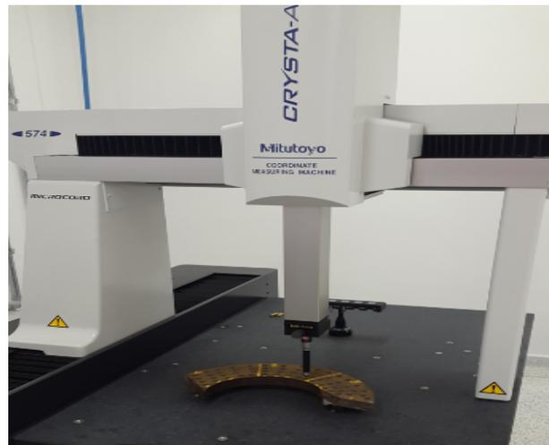
**Figura 7: Máquina de medir por coordenadas**
