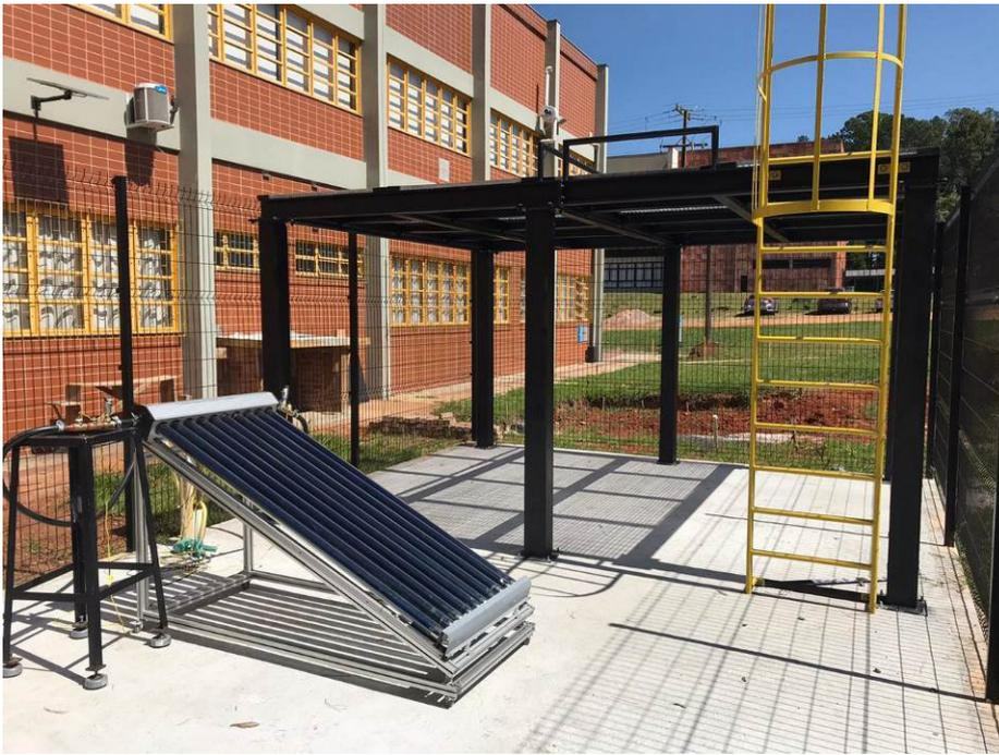
**Figura 3: Coletor Solar de Tubo a Vácuo em área externa do LabSOLAR/UTFPR/Ponta Grossa**
