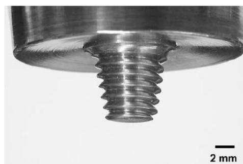
**Figura 11: Pino cônico com rosca esquerda. [1]**
