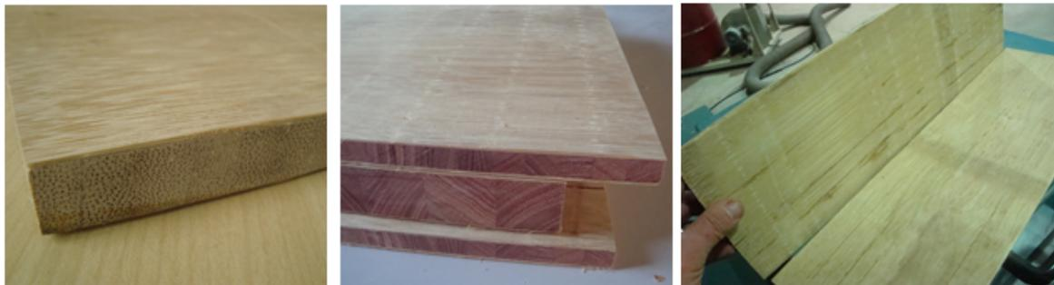
**Figura 14: Painéis sarrafeados de bambu e de eucalipto, revestidos com lâminas de bambu gigante e painel compensado com 3 camadas**
