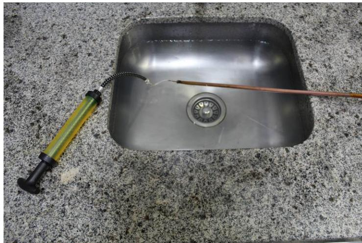
**Figura 9: Teste de Estanqueidade**
