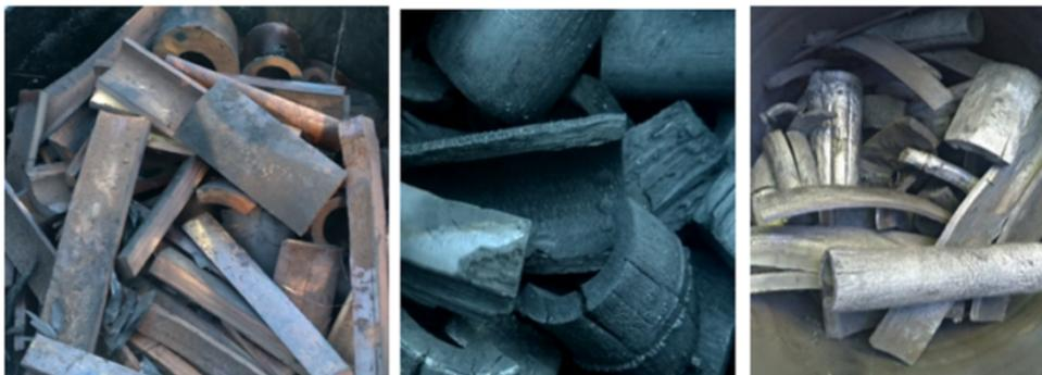
**Figura 2: Carvão de bambu produzido em diferentes tipos de fornos, semicarbonizado, carvão preto e carvão branco produzidos à alta temperatura**
