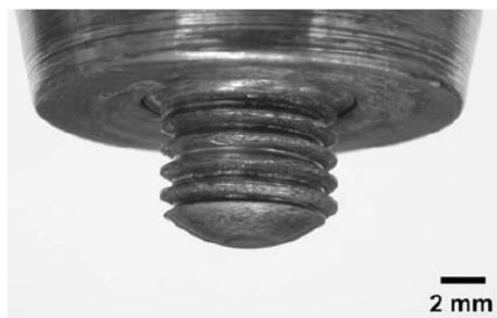
**Figura 9: Pino cilíndrico de fundo redondo com rosca esquerda. [1]**
