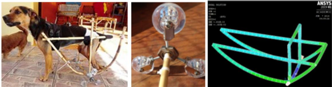
**Figura 10: Auxiliar para locomoção de cães feito em bambu, detalhe do eixo e rodas usado para superar obstáculos no piso e simulação de esforços na estrutura**
