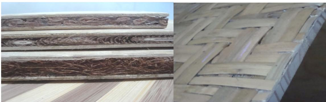
**Figura 15: Painéis tipo sanduíche, com capa de bambu laminado e miolo de grêmia de pinheiro e de casca de coco. Painel sarrafeado de pinus revestido com lâminas trançadas de bambu do gênero *Merostachys*.**
